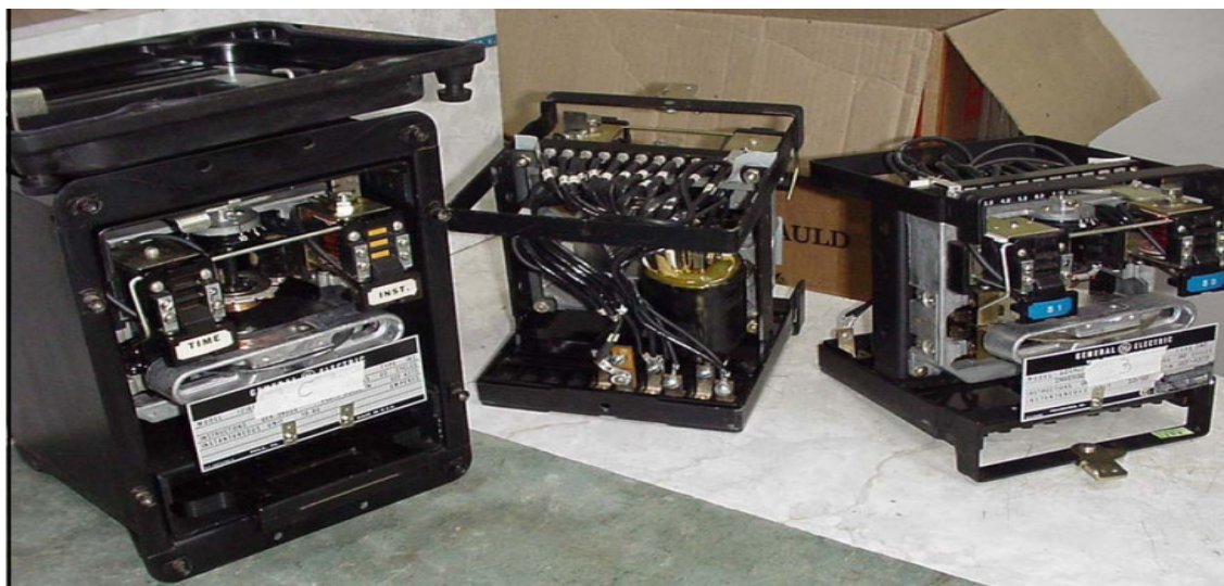
Foto 4.3.1: Relés eletromecânicos de General Electric tipo CO.
