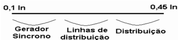
Figura 4.5.3: Zonas de ajuste do relé de neutro
